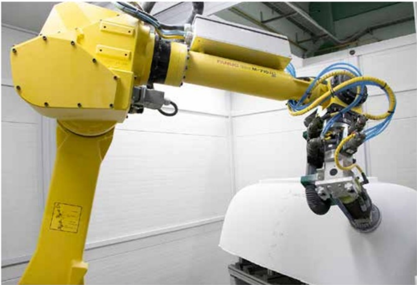
Robotsko brušenje kerrock kopalne kadi.
